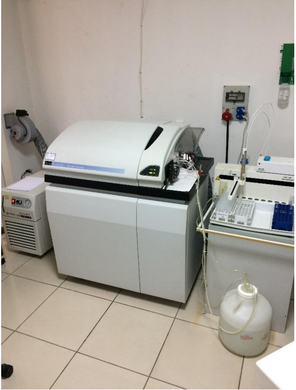
Şekil 3.5. Akdeniz Üniversitesi Gıda Güvenliği ve Tarımsal Araştırmalar Merkezi laboratuvarında bulunan ICP-MS cihazının görüntüsü
