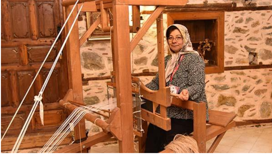
Fotoğraf 3.20 Alanya 'da İpek ve Pamuk Dokumasında da Kullanılan Bezayak (Culfalık) Tezgahlarda Muz Lifi İpler Dokunarak Kumaş Elde Edilmektedir.
