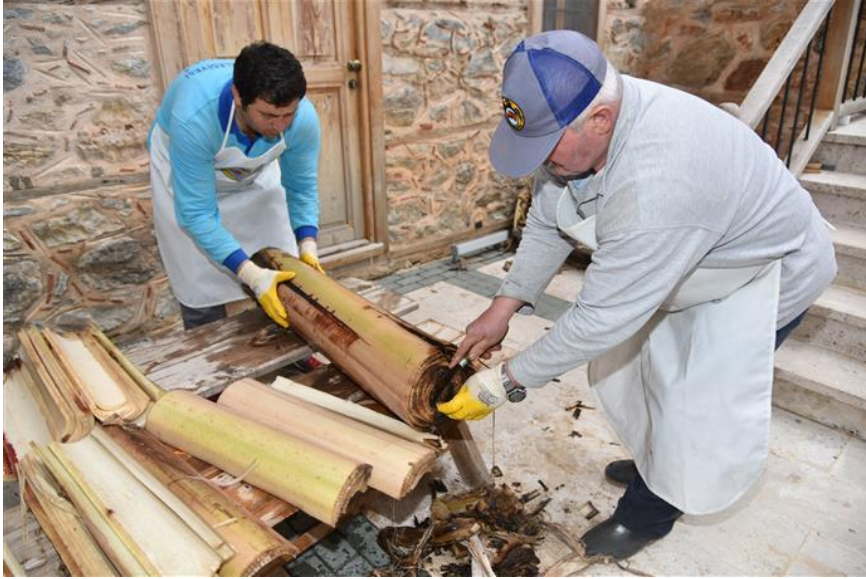
Fotoğraf 3.21 Muzun Meyvesi Kesildikten Sonra Geriye Kalan Muz Gövdelerinden Lif Elde Edilmesi İşlemi
