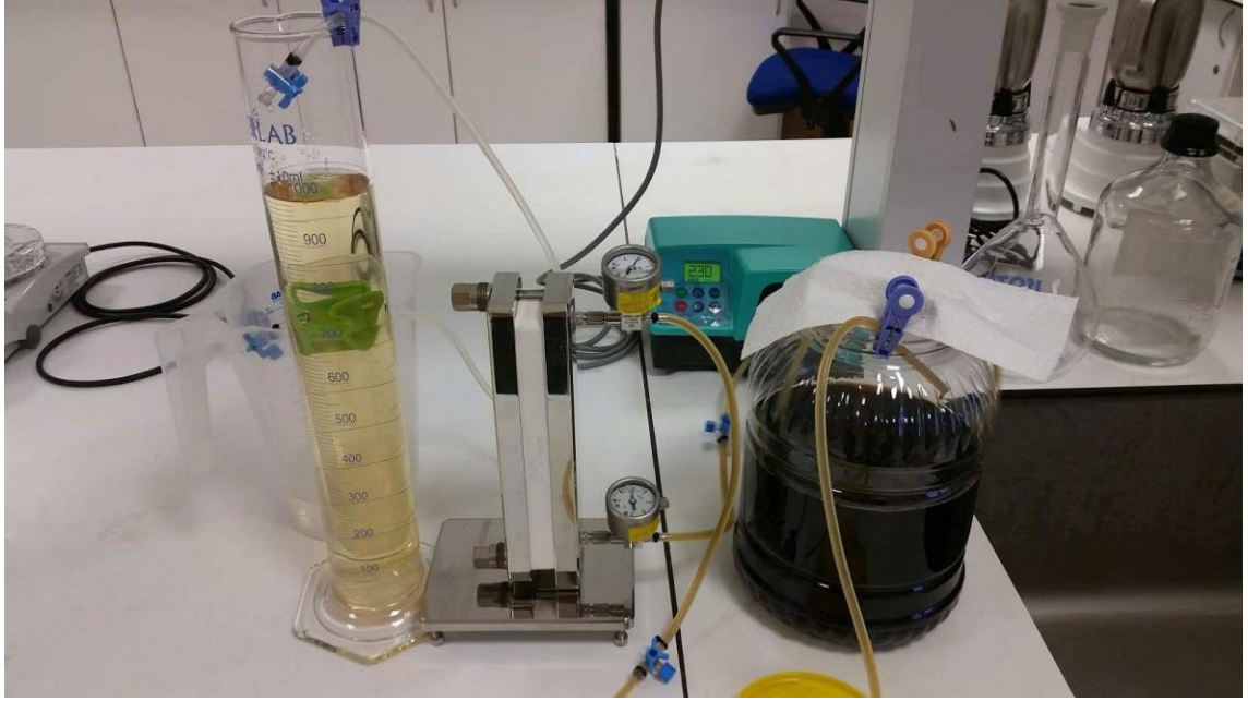
Şekil 3.4. Ekstraktların 5 kDa ayırma sınırına sahip membran ile nanofiltrasyonu
