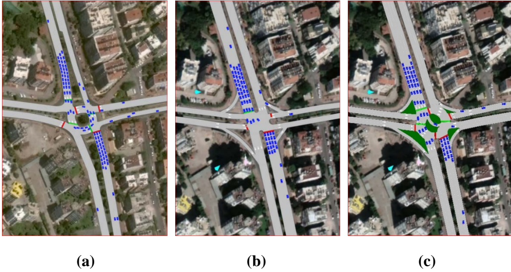
Şekil 4.2. Burhanettin Onat Caddesi-Metin Kasapoğlu Caddesi Kesişimi; a) 2016 Yılına Ait Durum; (b) 2017 yılına ait durum(Mevcut Durum); (c) Yeni Tip Sinyalize Dönel Kavşak Durumu Simülasyon Görüntüleri
