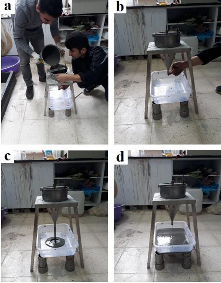
Şekil 3.5. Harcın akışkanlık deney aşamaları; a); b) boşalması; c); d) orifisten akış aşaması
