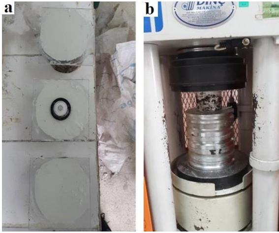
Şekil 3.12. Basınç dayanımı tayini deney düzeneği; a) başlık yapımı; b) deney aşaması
