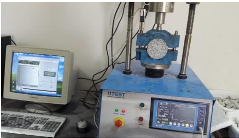
Şekil 3.10. Marshall stabilite ve akma deneyi
