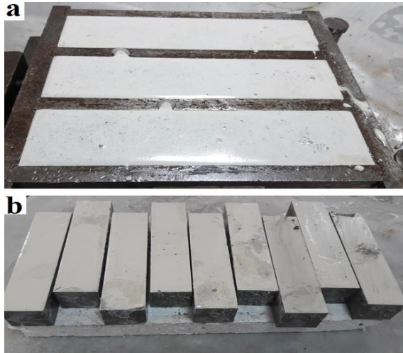
Şekil 4.2. Numunelerde kuma ve segregasyon
