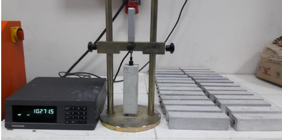
Şekil 3.8. Boy değişimi ölçümünde kullanılan düzenek ve numuneler
