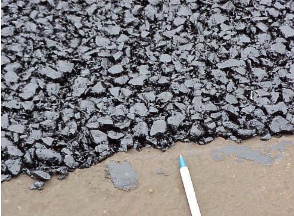
Şekil 2.1. Poroz asfalt kaplama yol yüzeyi (Randy 2007)
