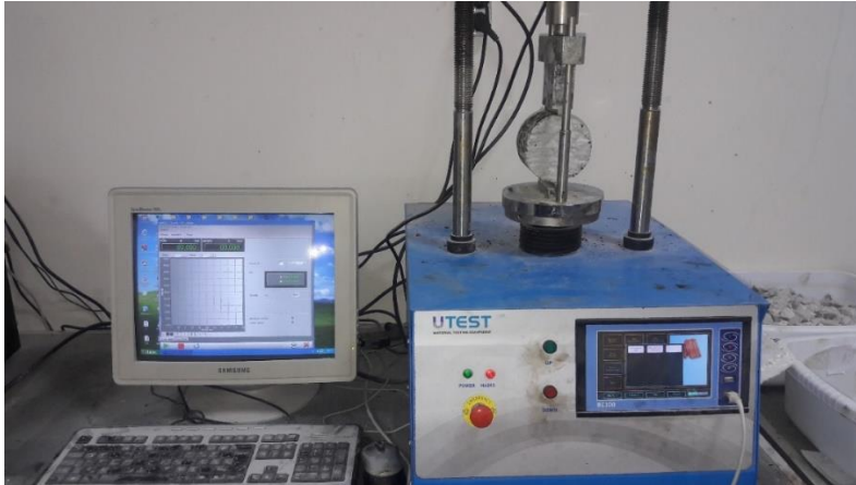
Şekil 3.11. İndirekt çekme deney düzeneği
