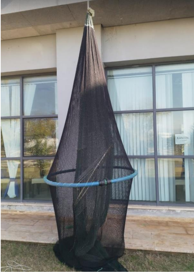
Şekil 3.5. Izgara takılan trol torbasının dışarıdan görünümü
