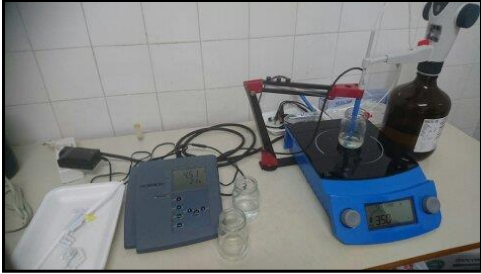
Şekil 3.11. Titre edilebilir asitlik miktarının belirlendiği titrasyon işleminden bir görünüm
