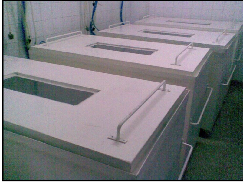
Şekil 3.3. 1-MCP uygulamalarının yapıldığı gaz geçirmez hücreler
