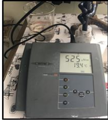
Şekil 3.10. Ortamlara ait pH ve EC değerlerinin belirlenmesi
