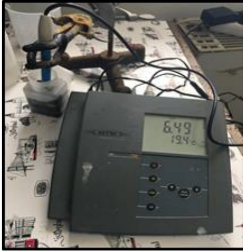
Şekil 3.10. Ortamlara ait pH ve EC değerlerinin belirlenmesi
