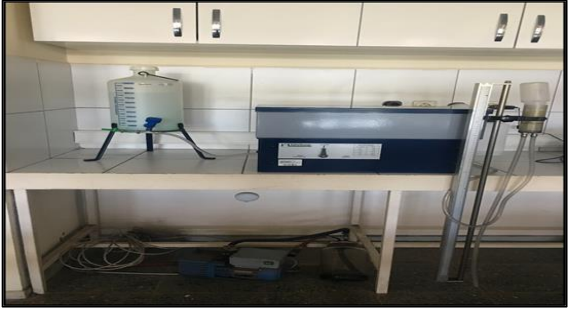
Şekil 3.8. Düşük tansiyon (pF) değerlerinde ortamların tuttuğu su miktarının belirlenmesinde kullanılan Sand-box aletinin görünümü.
