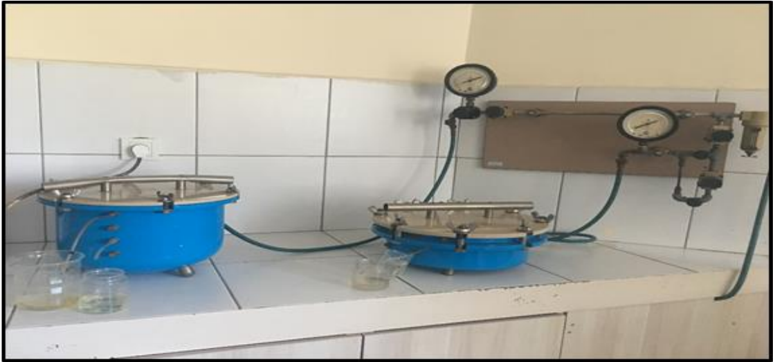
Şekil 3.9. Tarla kapasitesi (pF 2.54) ve solma noktası (pF 4.2) tayin aletleri
