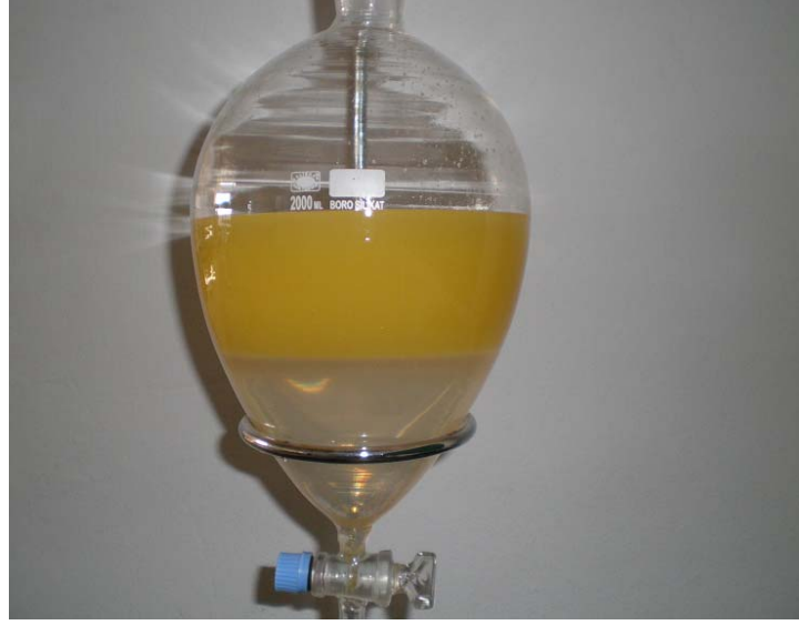
Şekil 3.5. Yıkama suyu ve metil ester fazlarının birbirinden ayrılması
