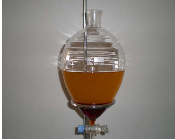
Şekil 3.4. Gliserin ve metil ester fazlarının birbirinden ayrılması
