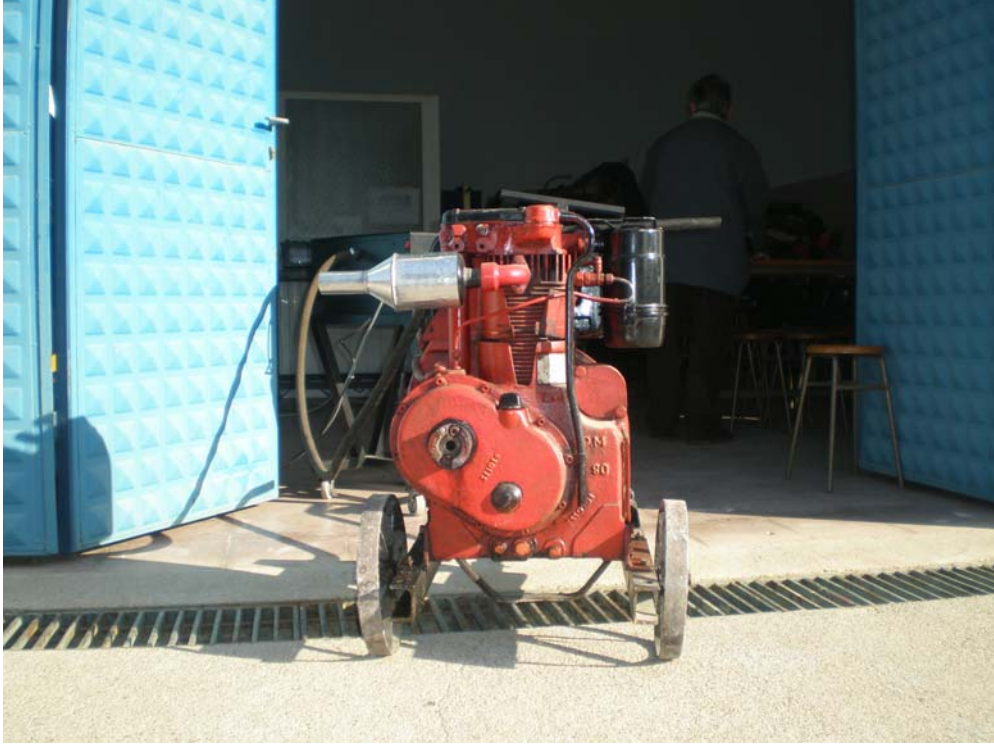
Şekil 3.6. Petrol dizeliyle harmanlanmış biyodizelin pancar motorunda yakıt olarak kullanımı
