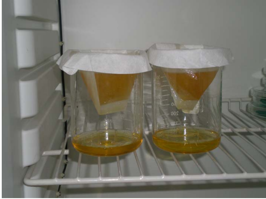
Şekil 3.2. Bitkisel atık yağın filtrasyonu
