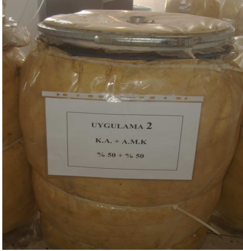
Şekil 3.3. Kompostlamanın gerçekleştirildiği reaktör
