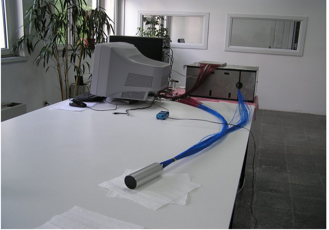
Şekil 3.31. 100'lük fiber prob, optik anahtar, optik tomografi cihazı
