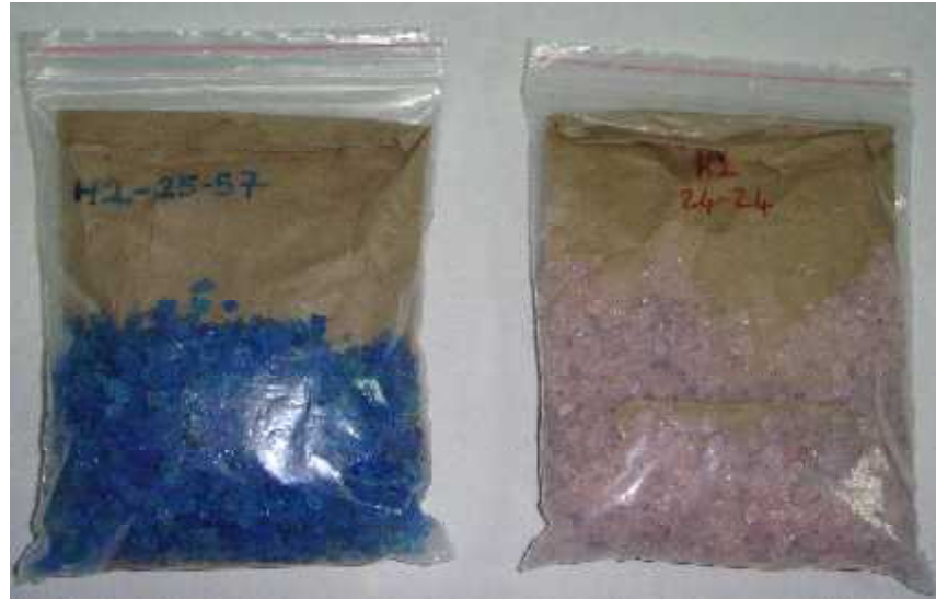
Şekil 2.8. Silika jeli değiştirilmiş bir örnek (soldaki, mavi silika jelli) ve silika jelinin değiştirilmesi gereken bir örnek (sağdaki, pembe silika jelli)
