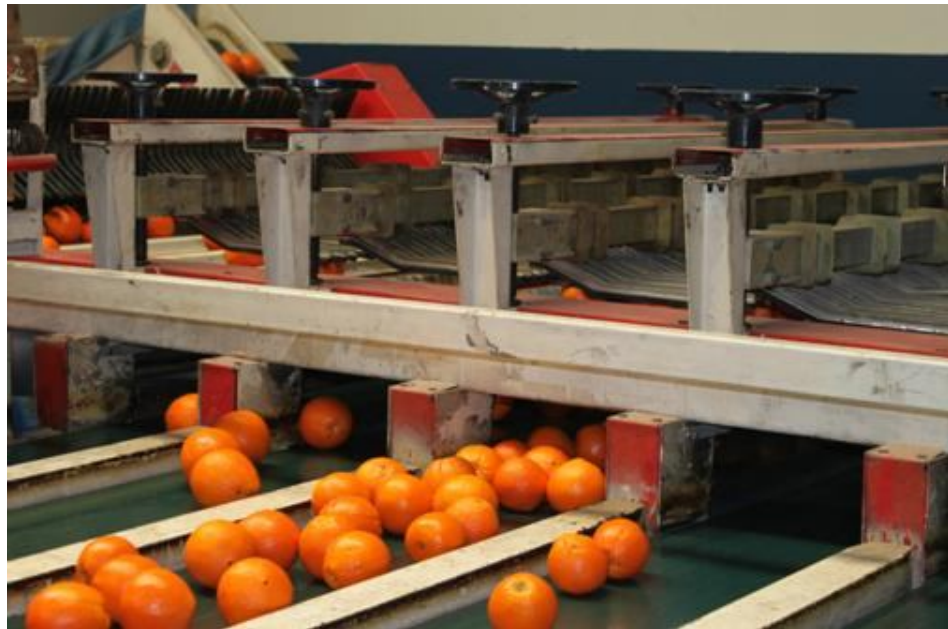
Resim 3.5 Turunçgil Paketleme Tesisinde Tuşlu (Piyano) Tip Boylama Sistemi (Eker Tarım)
