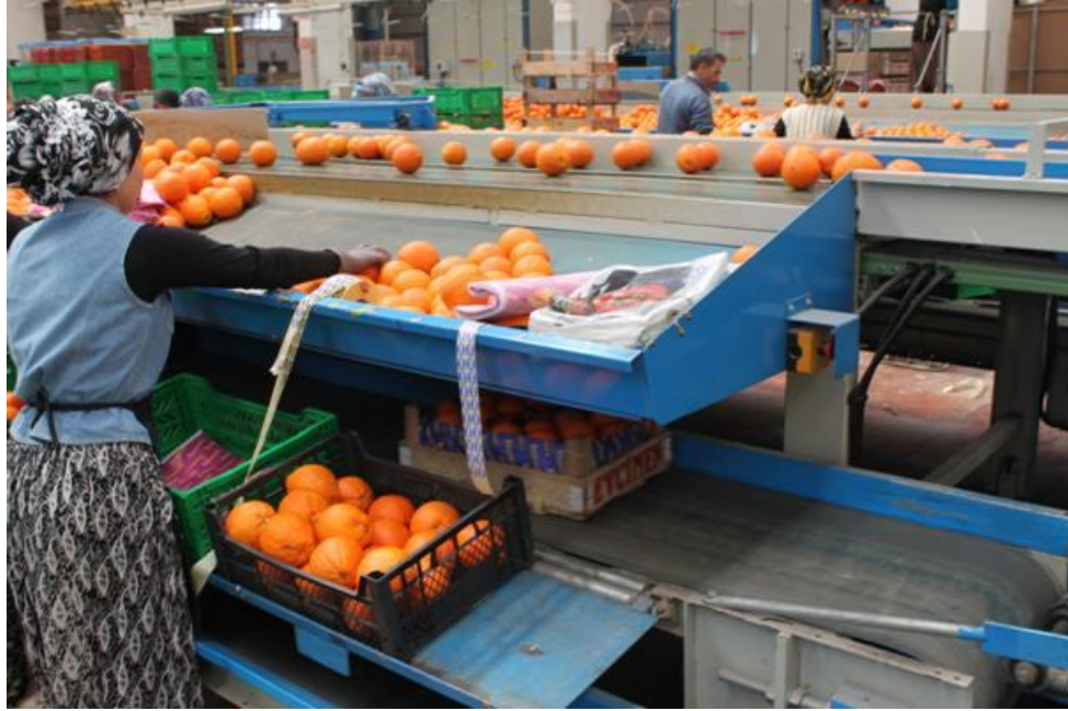
Resim 3.6 Turunçgil Paketleme Tesisinde Paketleme Masaları (Baysarı Tarım)
