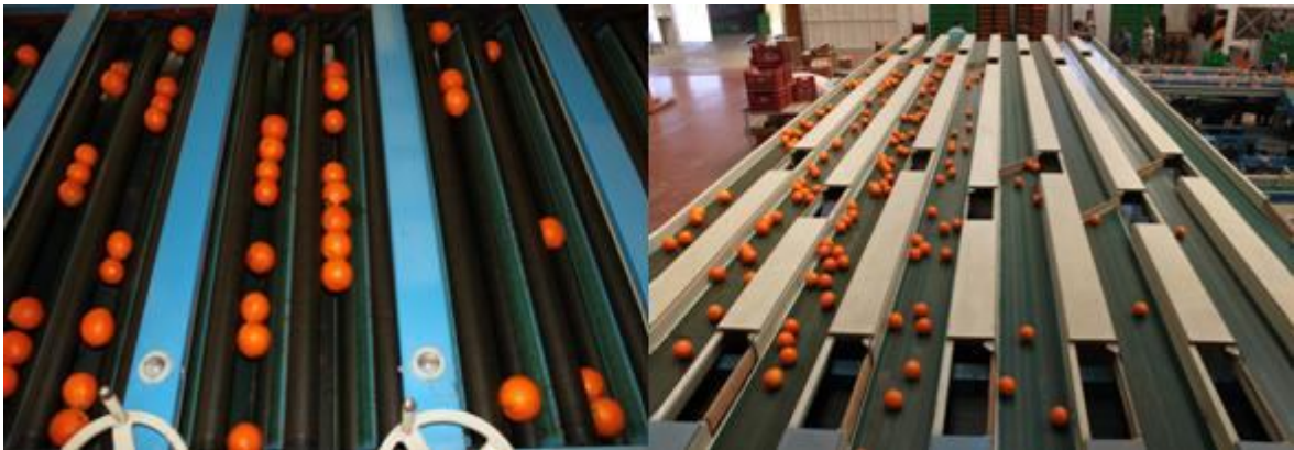
Resim 3.4 Turunçgil Paketleme Tesisinde Silindir Tip Boylama ve Dağıtım Bantları (Baysarı Tarım)
