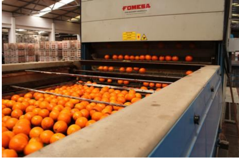
Resim 3.1 Turunçgil Paketleme Tesisinde Yıkama Sonrası Kurutma Tüneline Giden Meyveler (Baysarı Tarım)
