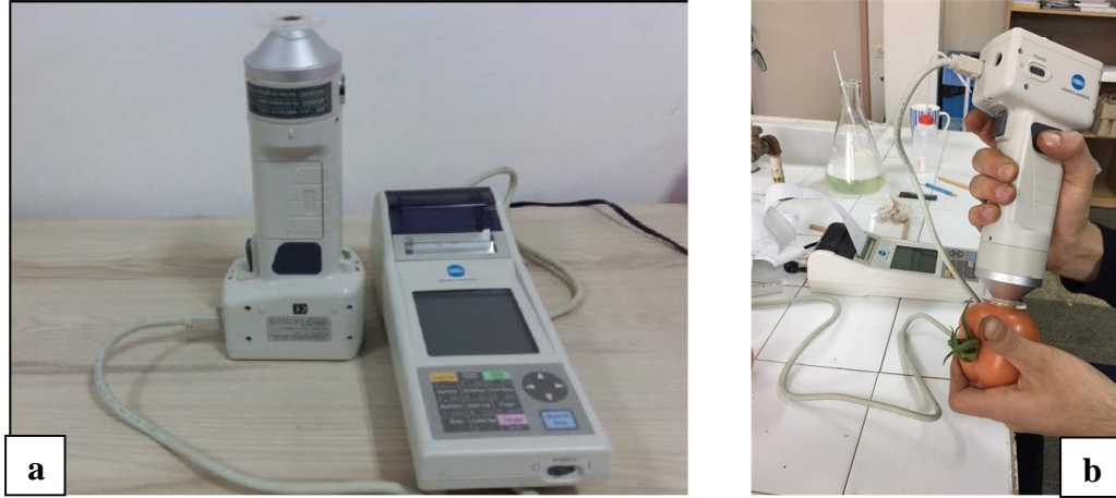
Şekil 3.9. Meyvelerde renk ölçümlerinin yapıldığı Minolta CR-400 cihazı (a), renk ölçümü (b)
