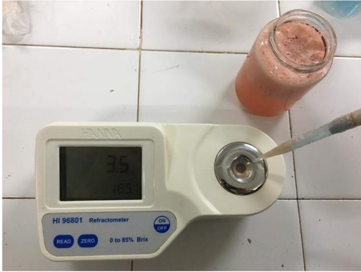
Şekil 3.12. SÇKM ölçümünde kullanılan dijital refraktometre
