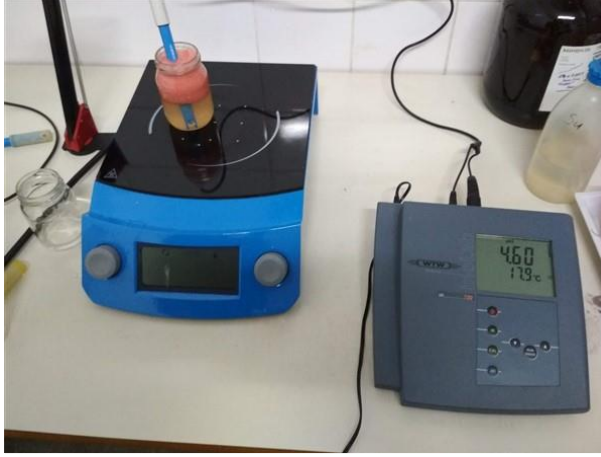
Şekil 3.14. Meyve suyu pH ölçümünde kullanılan pH metre
