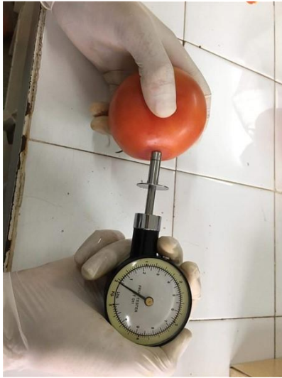
Şekil 3.11. Meyve eti sertliği ölçümü için kullanılan penetrometre
