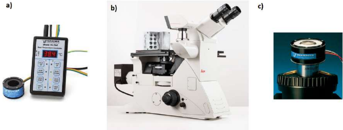
Şekil 3.11. a) Sıcaklık kontrol ünitesi (Warner Instruments TC-144) ; b) Işık mikroskobu (Leica DMI8) ; c) Objektif ısıtıcısı
