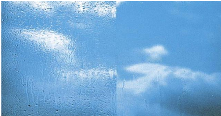
Şekil 1.5. Kendi kendini temizleme özelliğine sahip nanokaplama uygulanmış ve uygulanmamış cam malzeme yüzeyindeki su hareketi (Anonymuos 4)
