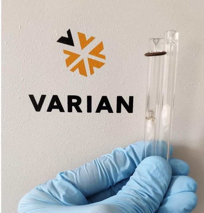
Şekil 3.9. Liner'da oluşan kirlilik birikimi, kirli ve temiz liner
