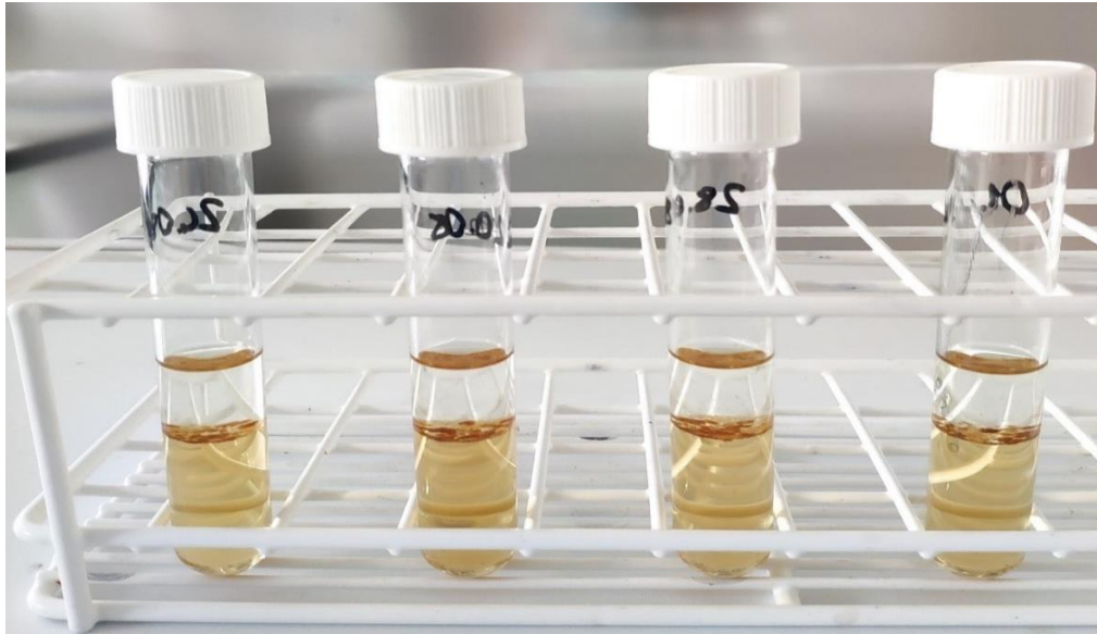
Şekil 3.10. Numunenin MTBE ekstraksiyonu sonunda fazlarına ayrılması
