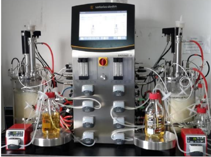
Şekil 3.1. Çalışmadaki fermentasyonların gerçekleştirildiği Biostat B (Sartorius Stedim Systems, Almanya) biyoreaktörü
