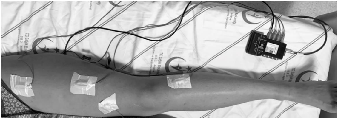
Şekil 3.3. Sol alt ekstremitte sırasıyla iliopsoas, rektus femoris, tibialis anterior kasları yüzey EMG elektrotları, diz eklemi üzerinde yer alan topraklama elektrotu yerleşimleri, diz eklemi lateraline yerleştirilen gonyometre ve DataLOG EMG cihazı gösterimi
