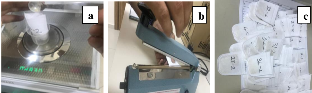
Şekil 3.9. F-57 torbalarının hazırlanması a) F-57 torbalarının tartılması; b) Heat Sealer ile torbaların kapatılması; c) Analiz için hazırlanmış F-57 torbaları
