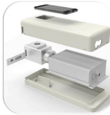
Şekil 2.1. Gong vd., genel amaçlı tasarladıkları portatif UCNP-LFA okuyucu (Gong vd. 2019)
