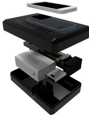
Őekil 2.4. You vd., BNP ve ST2 antijenlerini tespit etmek iin tasarladıkları portatif UCNP-LFA okuyucu (You vd. 2017)
