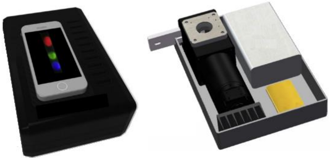
Şekil 2.3. Jin vd., besin güvenliği, tıbbi teşhis ve çevresel izleme amaçlı tasarladıkları portatif UCNP-LFA okuyucu (Jin vd. 2018)
