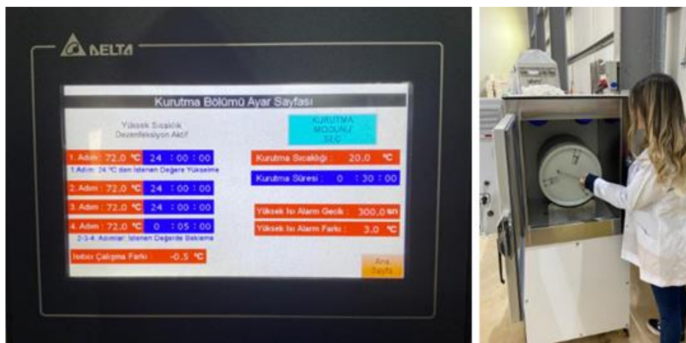
Şekil 3. 5. Kademeli olarak sıcaklık artışı gerçekleştiren ısıl işlem makinesi
