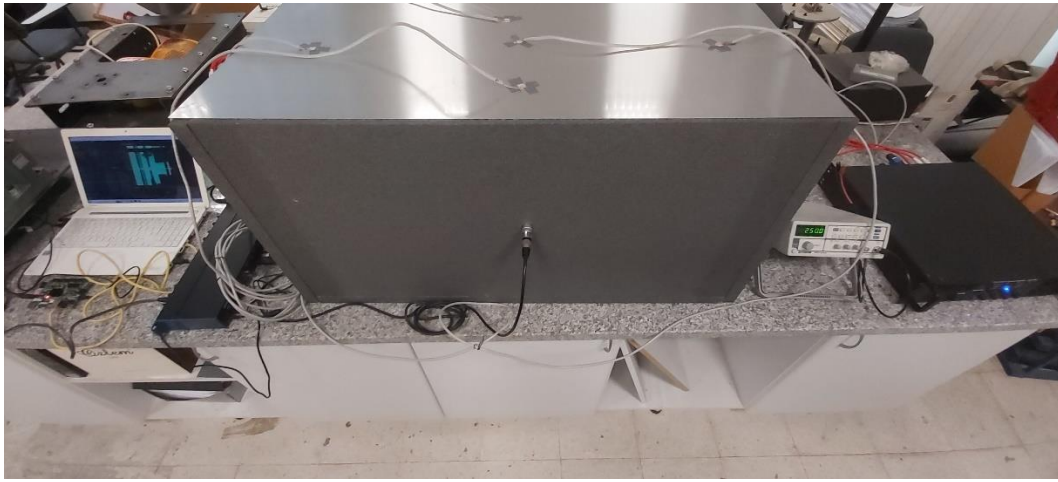
Şekil 3.3. İleri besleme aktif adaptif yapısal gürültü kontrolü deney düzeneği
