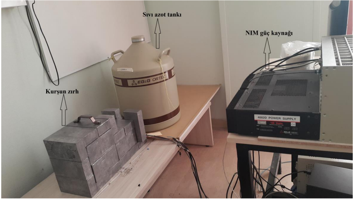
Şekil 3.15. Deneilerde kullanılan Akdeniz Üniversitesi Nükleer Bilimler Uygulama ve Araştırma Merkezi'ne ait HPGe dedektörü (NIM güç kaynağı, sıvı azot tankı ve kurşun zırh)
