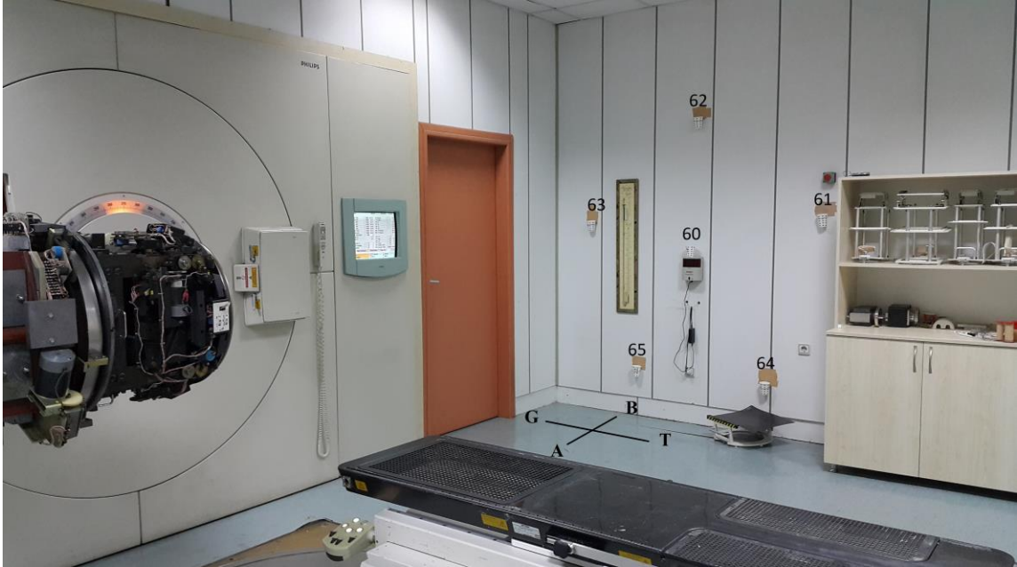
Şekil 4.19. Linear hızlandırıcı odasındaki fotonötron akı tayini için içerisinde indiyum ve kadmiyum yaprakları bulunan bardakların konumu (Deney düzeneđi V, B yönü)
