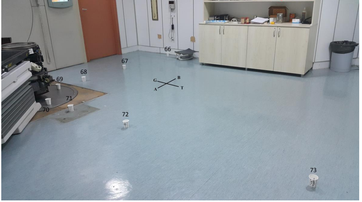
Şekil 4.24. Linear hızlandırıcı odasındaki fotonötron akı tayini için içerisinde indiyum ve kadmiyum yaprakları bulunan bardakların konumu (Deney düzenegi IV, B yönü)
