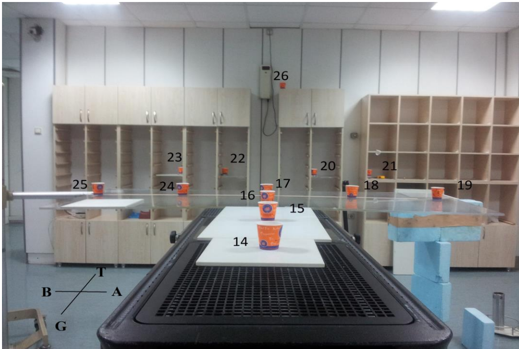
Şekil 4.5. Linear hızlandırıcı odasındaki fotonötron akı tayini için içerisinde indiyum ve kadmiyum yaprakları bulunan bardakların konumu (Deney düzeneği II, #14 bardak SSD=100 cm'de, 100 cm T yönünde)
