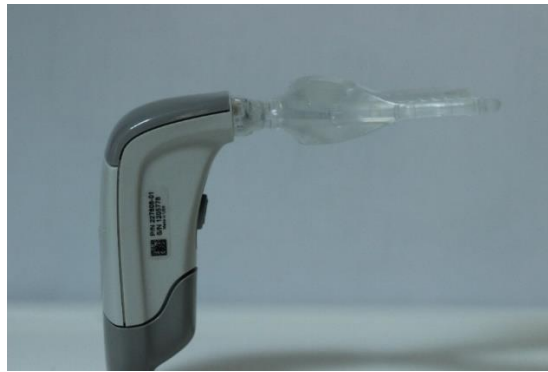
Şekil 3.8. Acceludent Aura' nın yandan görüntüsü, ağız içi parçayla aktivatör kısmı anahtar kilit uyumuna benzer mekanizmayla birleştirilmiş.
