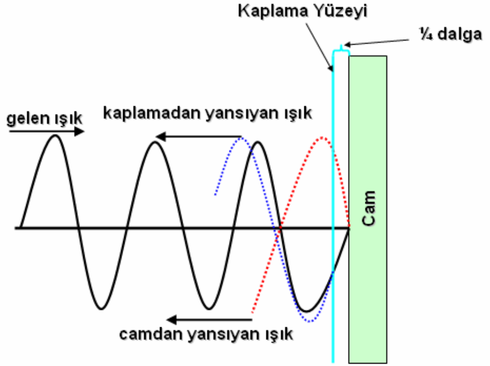
Şekil 1.5. Cam yüzeyinden ve cam yüzeyinde bulunan filmde yansıyan dalgalar birbirini söndürmektedir (camdan yansıma kırmızı, kaplamadan yansıma mavi ile gösterilmiştir)
