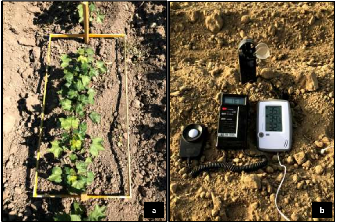
Şekil 3.7. a) Sıra üzerinde oluşturulan çakılı alanlar; b) Üstte anemometre, termometre ve higrometre solda lüxmetre, sağda toprak termometresi
