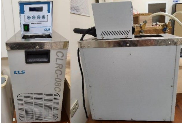
Şekil 3.17. Çalışmada kullanılan sabit sıcaklıklı su banyosunun önden ve yandan görünümü
