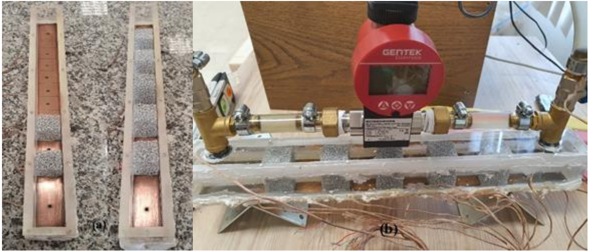
Şekil 3.16. Metal köpük ısı alıcıların montajı a) Montaj noktaları; b) Test bölgesinde görünümü
