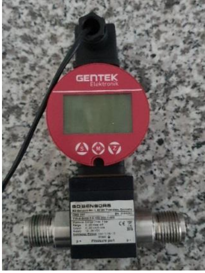
Şekil 3.18. Çalışmada kullanılan fark basınç transmitteri ve dijital göstergenin görünümü
