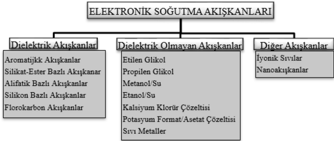
Şekil 2.5. Elektronik soğutma sistemlerinde kullanılan bazı akışkanlar (Mohaparta 2006)
