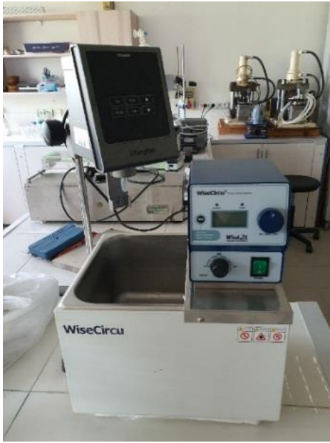
Şekil 3.7. Ölçümlerde kullanılan viskozimetre ve sabit sıcaklıklı su banyosunun görünümü
