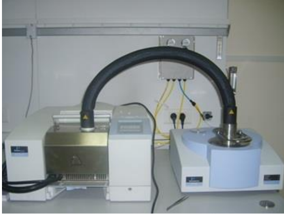
Şekil 3.4. TGA/FTIR entegre analiz cihazı (Merlab)
