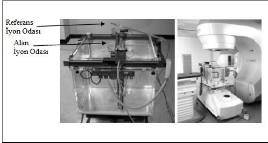
Şekil 1. 16. Dedektör konumları ve su fantomu sistemi (Podgorsak 2005; Mayles vd. 2007)
