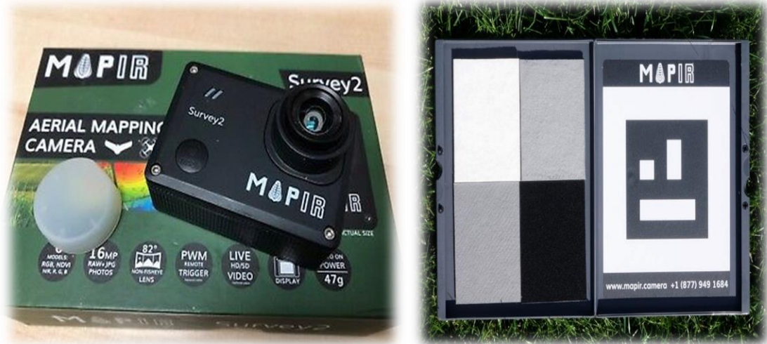
Şekil 3.5. Denemede kullanılan MAPIR Survey 2 kamera ve kalibrasyon paneli
