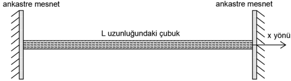
Şekil 3.3. Her iki ucu da tutulu (ankastre mesnet) aksel çubuk
